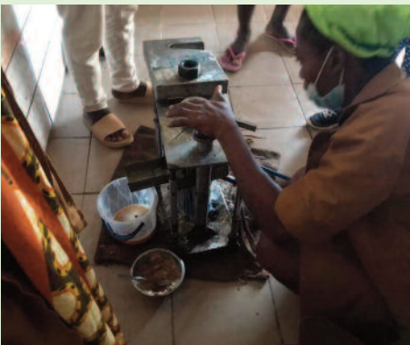
Presse manuelle permettant de séparer le beurre (huile) de la poudre de cacao
